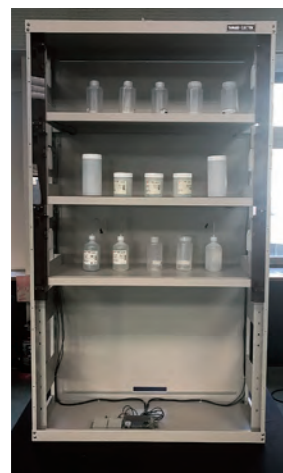
地震発生時に自動で蛇腹付きバーが上がり、収容物落下を防ぐ(落下センサー)
